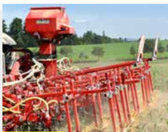
CHOPSTAR-ROLL Roterende schoffelmachine voor ruggenteelt (aardappel) tot 80 cm
