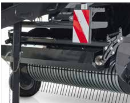
5. Veerbelaste tanden en een zware gewasrol (Ø 217 mm) voor verbeterde voorverdichting en gewasstroom
