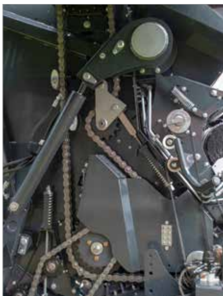
10. Robuuste aandrijflijn met slijtvaste en overbemeten kettingen
