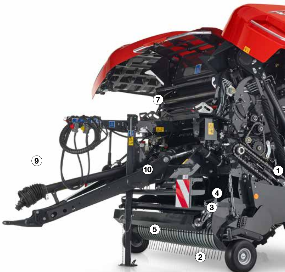
1. Tweede aandrijfrol waarborgt veilige riemaandrijving onder alle gewasomstandigheden
