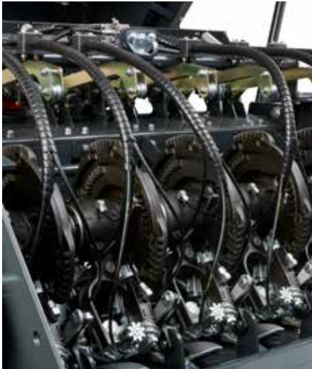
1. Dubbele knopersysteem met standaard elektronische bewaking
