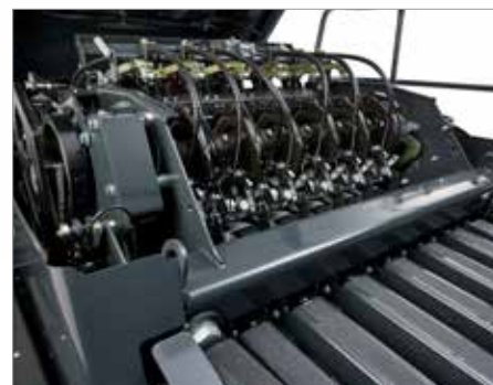
4. Dubbele knopersysteem met standaard elektronische bewaking
