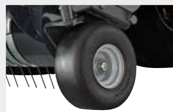
Semi-pneumatische zwenkbare pick-up-geleidewielen
