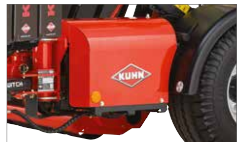
Een groot zijpaneel dat de hydraulische unit beschermt, biedt goede toegankelijkheid voor onderhoud
