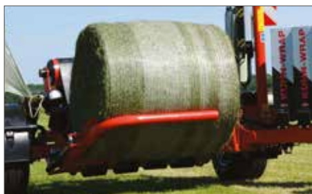
Snel en zachtjes laden van de baal gewaarborgd dankzij de lange laadarm
