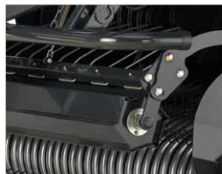
4. Zwaar uitgevoerde gewasrol met windscherm (Ø 217 mm)
