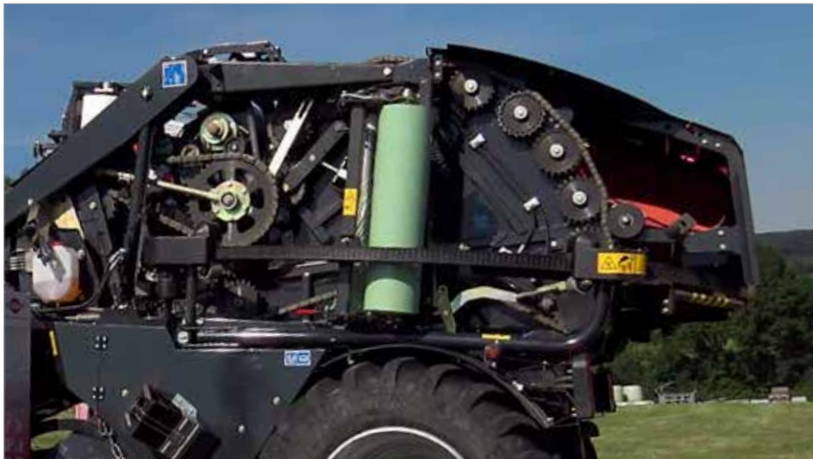
1. Robuuste aandrijflijn met IVIS-kettingen van hoge kwaliteit
