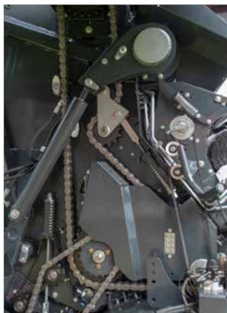
8. Robuuste over-gedimensioneerde aandrijflijn met slijtvaste- en grote kettingen
