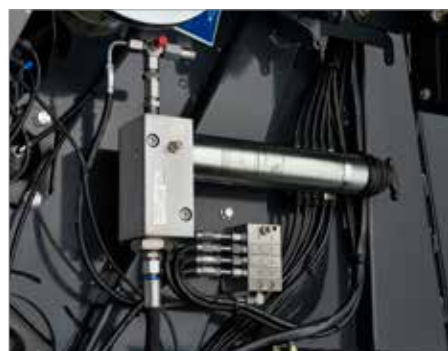
5. Standaard automatisch smeersysteem voor rol-lagers
