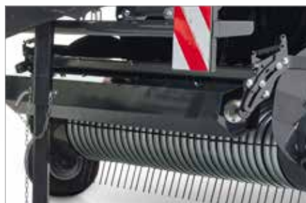
5. Zwaar uitgevoerde gewasrol met windscherm (Ø 217 mm)
