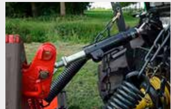
FRONTFLEX telescopische topstangverbinding (uitsluitend in combinatie met vaste aanbouwbok)
