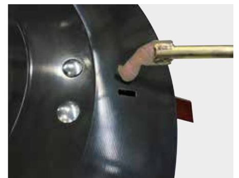
4. Messenwisselsysteem met speciaal gereedschap en meshouder
