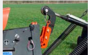
FLEXTOP flexibele topstangverbinding (uitsluitend in combinatie met vaste aanbouwbok)
