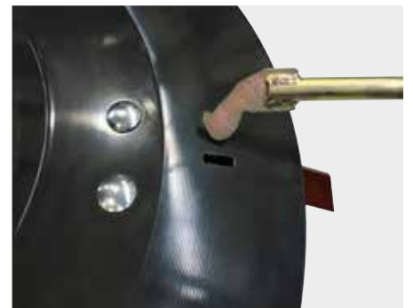
4. Messenwisselsysteem met speciaal gereedschap en meshouder
