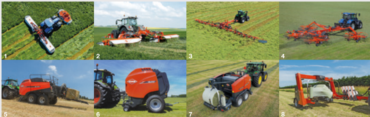
1. Triple maaier - 2. Triple maai-knikschudder - 3. Grote cirkelschudder - 4. 4-rotorhark - 5. Rondebalerpers - 6. Balenpers-wikkelcombinatie met vaste kamer - 7. Wikkelaar.
