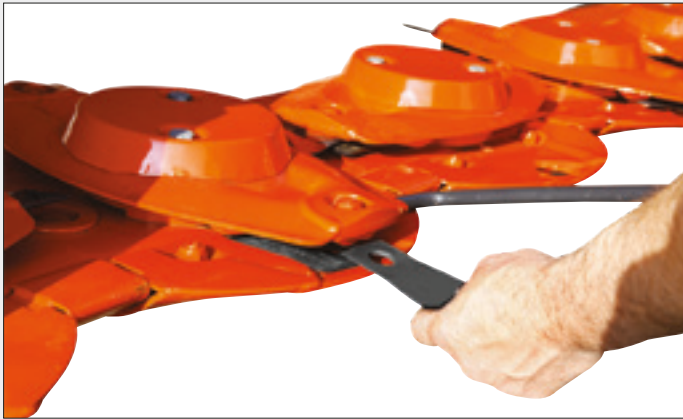
FAST-FIT-snelwisselsysteem: de messen kunnen snel vervangen worden.
