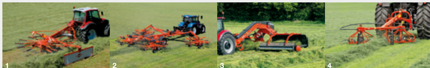
1. Gedragen cirkelharken met één rotor - 2. Halfgedragen cirkelharken met 4 rotoren - 3. Bandharken - 4. Harkschudders
