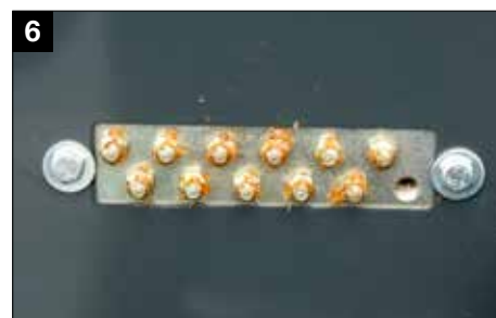
Centraal smeringssysteem voor persrollen
