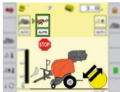
Zicht op de automatische werking van de achterklep
