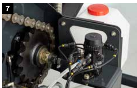
BEKA-MAX continu kettingsmeringssysteem
