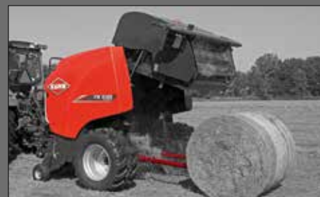
Balenwerper signaleert wanneer een baal buiten bereik is. De achterklep gaat niet verder open dan nodig. De achterklep sluit automatisch
