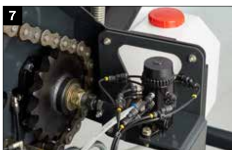
BEKA-MAX continu kettingsmeringssysteem
