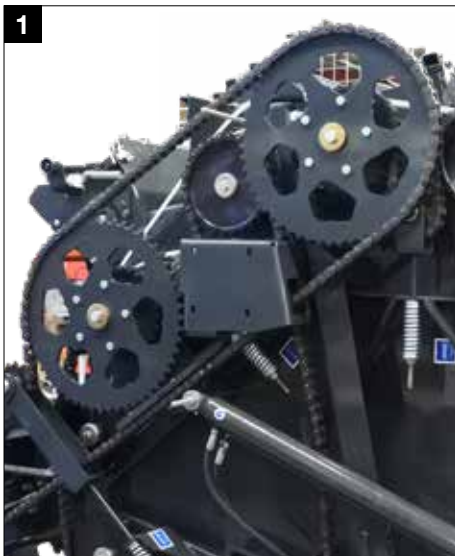
Eenvoudige aandrijving met slechts drie hoofkettingen
