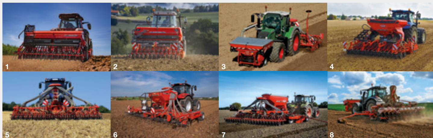
1. Mechanisch gemonteerd 2. Geïntegreerd mechanisch 3. Met fronttank 4. Geïntegreerd pneumatisch 5. Getrokken pneumatisch 6. Gemonteerde cultivator 7. Getrokken cultivator 8. Precisiezaaimachines
